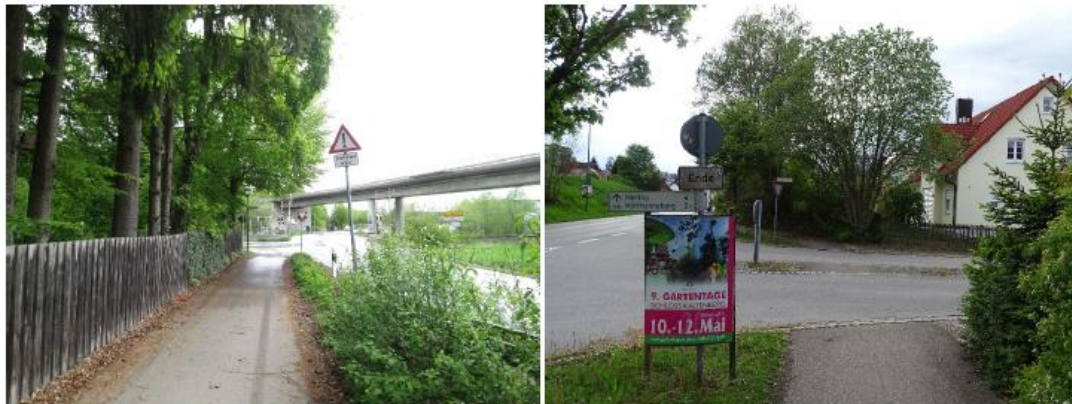
Abb. 59: Stark eingeschränkte Sicht an Kreuzungen durch Einbauten und Bewuchs
